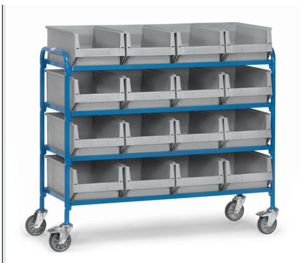
Ensemble mécano-soudé, revêtement époxy bleu RAL 5007. 4 plateaux en mélaminé surface effet hêtre avec rebord de 10 mm et 16 bacs (L x l x H : 500/450 x 312 x 200 mm). 4 roues pivotantes à bandage TPE, moyeu à roulement à billes. 2 roues avec freins conformément à la Norme EN 1757-3. Charge par plateau : 60 kg.
